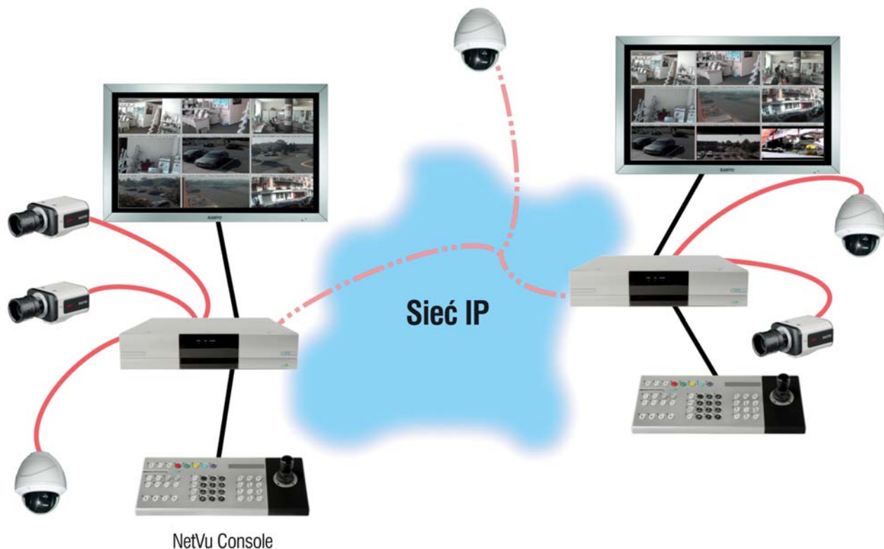
Rys. 1. Schemat prostego systemu obsługiwanego przez konsole NetVuConsole
