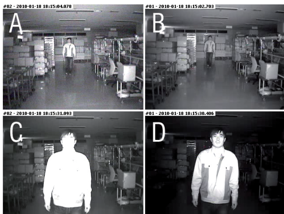
Fot. 1. Klasyczne podświetlenie - General IR (A,C) oraz podświetlenie adaptacyjne - Intelligent IR (B,D)
