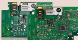
TL265GS, GS2065 Komunikatory alarmowe wysyłające kody raportujące przez sieć GSM/GPRS i TCP/IP
