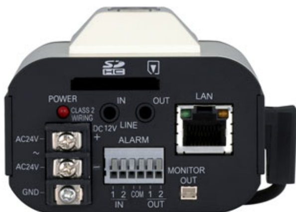
Fot. 2. Panel tylny kamery sieciowej Sanyo VCC-HD2500P
