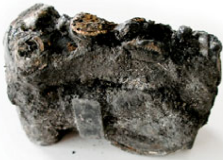
Fot. 4. Spalony aparat z którego odzyskano zdjęcia w laboratorium Kroll Ontrack
