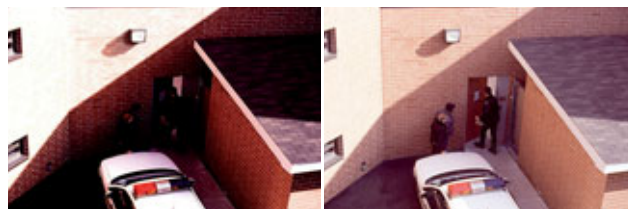
Fot. 1. Porównanie efektu dwóch technologii przetwarzania obrazu. Po lewej obraz przetworzony przez filtr 8-bitowy, po prawej – przez filtr 15-bitowy
