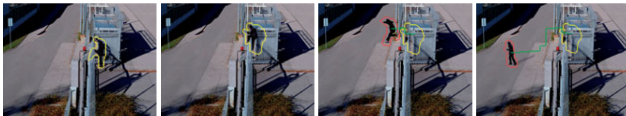
Fot. 2. Sekwencja ukazująca działanie IVA. Na obraz nałożone zostały metadane w formie graficznej. Kolor żółty oznacza działanie analizy, lecz obiekt nie spełnił warunku (przekroczenie linii ogrodzenia). Kolorem czerwonym oznaczony jest obiekt, który spowodował uruchomienie alarmu. Zielona linia ukazuje trajektorię poruszania się obiektu
