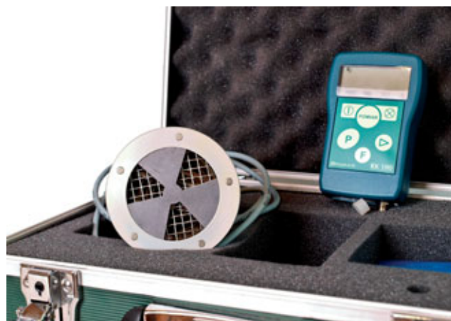
Fot. 2. Radiometr RK-100 z sondą zewnętrzną
