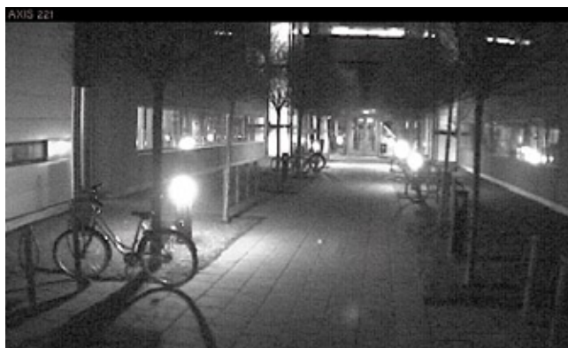
Fot. 2. Ochrona perymetryczna obszaru nieoświetlonego nocą, o 22:40. Niżej, po lewej stronie – dobrej jakości kamera analogowa przeznaczona do pracy w warunkach słabego oświetlenia. Niżej, po prawej stronie – AXIS Q1602-E z Lightfinder. W przypadku braku oświetlenia AXIS Q1602-E jest w stanie dostarczyć kolorowego obrazu, podczas gdy kamera analogowa daje obraz czarno-biały
