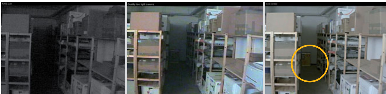
Fot. 4. Nadzór magazynu w warunkach słabego oświetlenia. Z lewej strony – AXIS 221. Na środku – dobrej jakości kamera analogowa przeznaczona do pracy w warunkach słabego oświetlenia. Z prawej strony – AXIS Q1602-E z Lightfinder. Identyfikacja kolorów w materiale dostarczonej przez AXIS Q1602 jest łatwiejsza, a obraz jest mniej zaszumiony i ostrzejszy niż obraz z kamery analogowej
