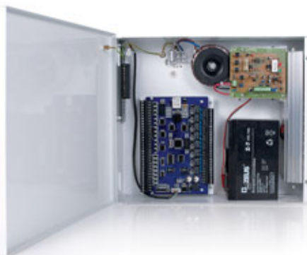
Fot. 1. Kontroler w obudowie zasilacza buforowego
