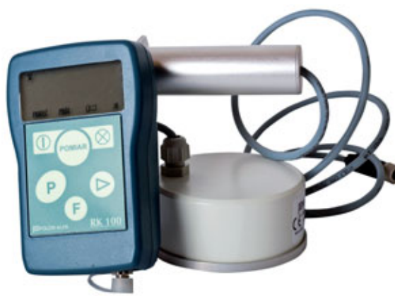
Fot. 4. Radiometr RK-100 z dołączoną sondą zewnętrzną
