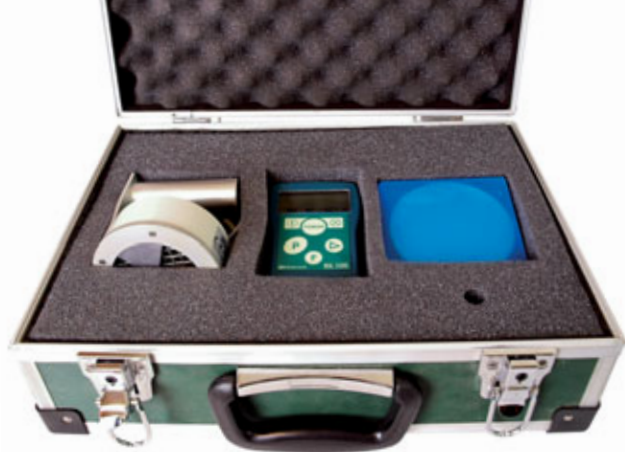
Fot. 1. Radiometr uniwersalny RK-100 w zestawie
