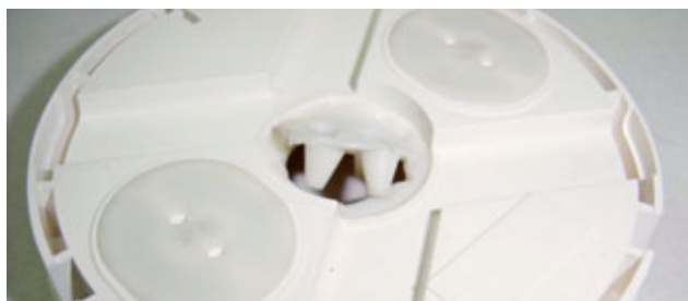
Fot. 2. Nieuwzględnienie zaleceń zawartych w dokumentacji dotyczącej urządzenia – zniszczenie uszczelnień gniazda czujki
