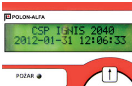
Rys. 2. Podświetlany wyświetlacz LCD (2×20 znaków)
