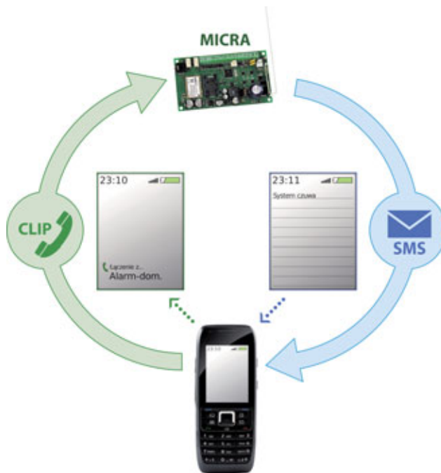
Rys. 1. Wystarczy wysłać SMS lub zainicjować połączenie z numerem modułu MICRA (tzw. "CLIP"), aby załączyć lub wyłączyć czuwanie
