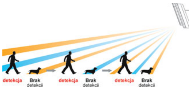
Rys. 1. Inteligentny algorytm detekcji czujek HX
