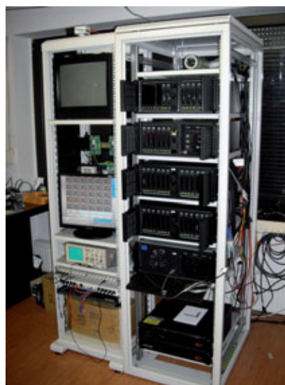
Fot. 2. Aktualne stanowisko testowania rejestratorów hybrydowych i sieciowych (2012)
