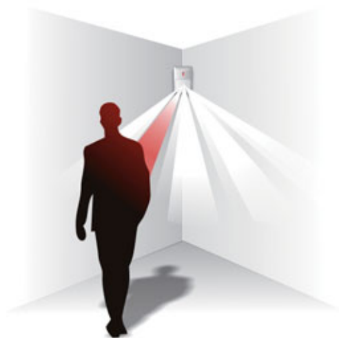
Rys. 6. Intruz poruszający się w pomieszczeniu emituje promieniowanie z zakresu podczerwieni, które jest odbierane przez czujkę z wykorzystaniem przestrzennego układu wiązek optycznych. Pyroelement zamienia energię promieniowania na sygnał elektryczny analizowany w procesorze sygnałowym, który jest odpowiedzialny za podanie informacji o alarmie.
