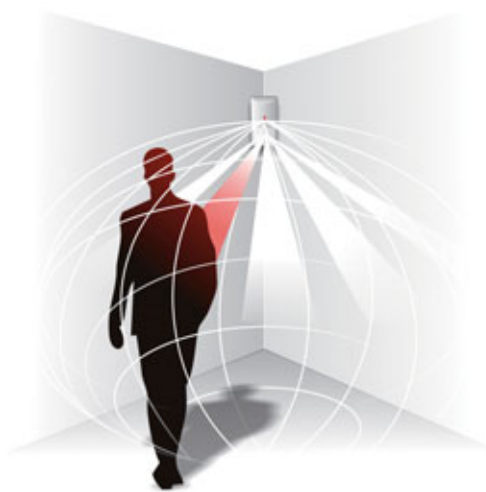
Rys. 8. Intruz poruszający się w pomieszczeniu emituje promieniowanie z zakresu podczerwieni, które odbierane jest przez tor podczerwieni czujki z wykorzystaniem przestrzennego układu wiązek optycznych. Jednocześnie ruch ten wykrywany jest przez tor mikrofalowy dzięki wykorzystaniu efektu Dopplera. Oba sygnały, z pyroelementu zamieniającego energię promieniowania na sygnał elektryczny, oraz z toru mikrofalowego trafiają do procesora sygnałowego, który na podstawie algorytmu opracowanego w firmie SATEL podejmuje decyzję o sygnalizacji alarmu.
