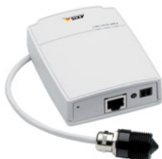
Fot. 2. Kamera AXIS P12 może być ukryta za ścianą – potrzebny jest jedynie niewielki otwór na obiektyw. Obiektyw może też całkowicie wystawać ze ściany
