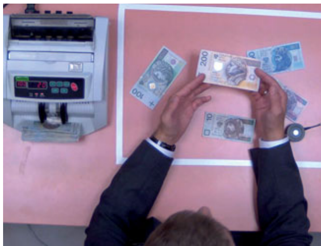
Fot. 2. Rozpoznanie numerów seryjnych banknotów, obszar rozpoznania: 850×640 mm, kamera 5 Mpx
