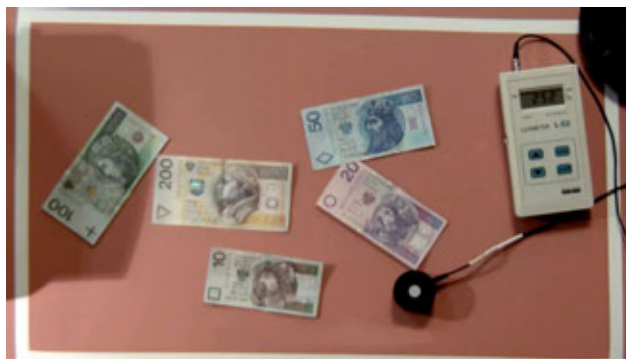
Fot. 3. Pogorszenie jakości obrazu i zdolności do rozpoznawania numerów w przypadku natężenia oświetlenia wynoszącego 200 luksów
