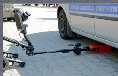
Fot. 4. Wydobywanie niebezpiecznego ładunku spod samochodu
