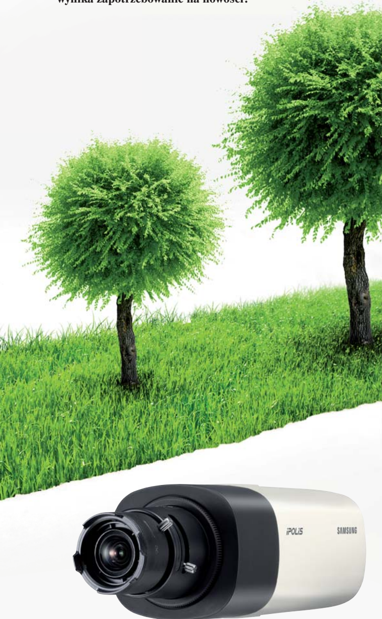
Fot. 2. Kamera Samsung SNB-6004 z funkcjami „Simple Focus” i „P-Iris”, pracująca w trybie dziennym i nocnym
