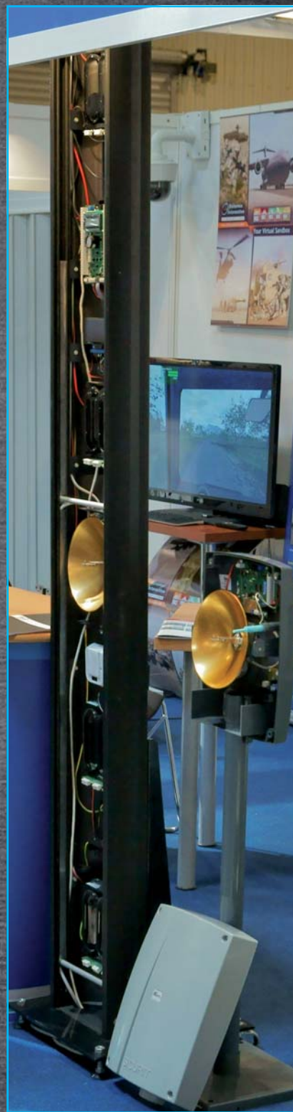
Fot. 8. Wielowiązkowa bariera służąca do ochrony obwodowej
