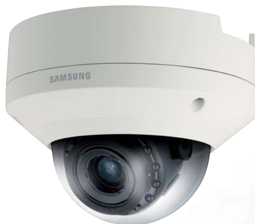
Fot. 1. Kamera wandaloodporna Samsung SNV-6084R o stopniu szczelności IP66, z funkcją „Simple Focus”, obiektywem typu „varifocal”, oświetlaczem IR, pracująca w trybie dziennym i nocnym
