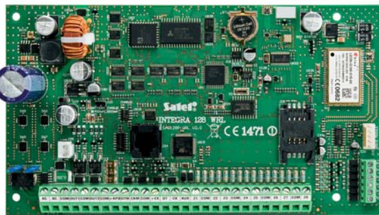
Fot. 1. Centrala INTEGRA 128 WRL dzięki swojej bogatej funkcjonalności umożliwia tworzenie inteligentnych instalacji łączących w ramach jednego systemu zarówno urządzenia przewodowe, jak i bezprzewodowe
