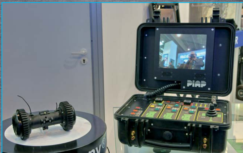
Fot. 5. Mały robot wyposażony w kamerę telewizyjną
