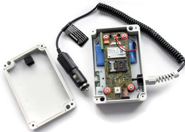
Fot. 1. Lokalizator GPS w wersji z przyłączem do gniazda zapalniczki
