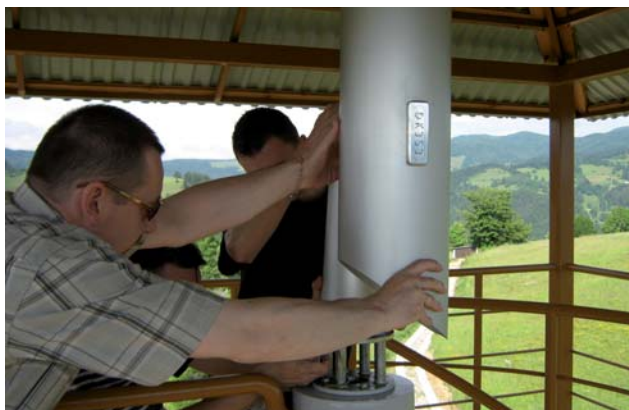
Fot. 4. Kamera DK3S3 z 55-krotnym zoomem użyta do obserwacji terenów górskich
