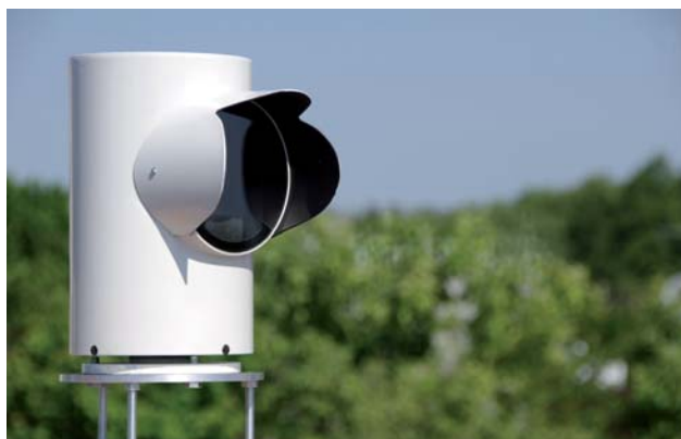
Fot. 3. Kamera DK4HDC dostosowana do obserwacji terenów zalesionych
