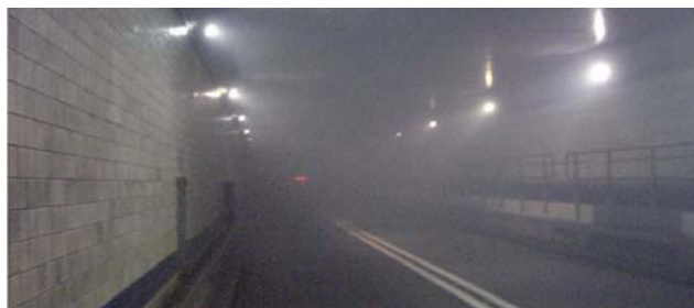
Fot. 1. Test pożarowy w tunelu. Duża koncentracja dymu i odległość to utrudnienia dla optycznych czujek płomienia
