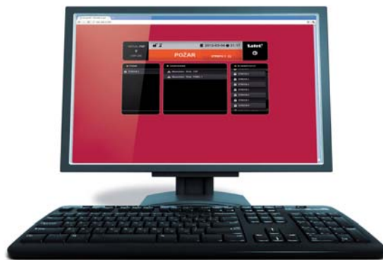
Fot. 2. Uzupełnieniem paneli wyniesionych w zakresie zdalnego nadzorowania pracy systemu CSP jest panel wirtualny, dzięki któremu można uzyskać zdalny podgląd stanu systemu w przeglądarce internetowej
