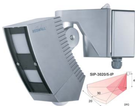
Rys. 2. Czujkę REDWALL-V można zamontować na szczelnej puszcze montażowej, w której umieszczony jest koder PIE-1. Wejście sabotażowe kodera można wykorzystać także do wykrywania otwarcia szafki montażowej
