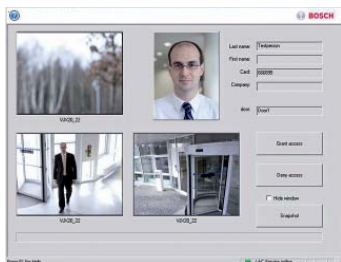
Fot. 3. Wizyjna weryfikacja przyczyn zdarzeń zachodzących w systemie kontroli dostępu ma zastosowanie w ochronie najważniejszych stref i pomieszczeń w zakładzie. Scenariusz weryfikacji jest elastyczny i może być konfigurowany indywidualnie. Operator systemu KD potwierdza tożsamość osoby przykładającej kartę do czytnika dzięki obrazom z kamer i zdjęciom przechowywanym w rejestrze. Z jednym czytnikiem można powiązać maksymalnie pięć kamer. Operator może sprawdzić, czy za pracownikiem, którego tożsamość jest weryfikowana, nie stoi kolejna osoba i czy do chronionego pomieszczenia nie dostał się ktoś niepowołany
