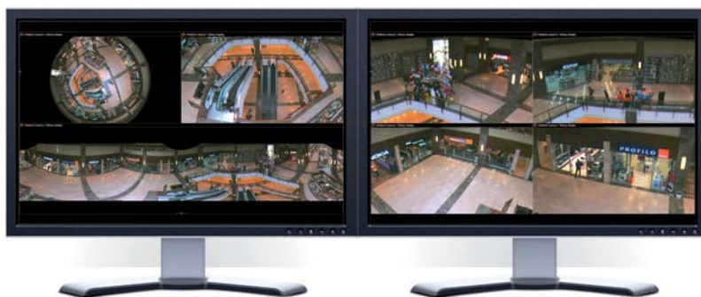
Fot. 4. Widok z jednej kamery Oncam Grandeye 360° prezentujący technologię dewarpingu – korekcji zniekształceń obrazu pochodzącego z kamery z obiektywem typu rybie oko. Na ekranach widać symultaniczne, różne obrazy z jednej kamery: obrazy przybliżone, panoramę i podgląd szerokokątny
