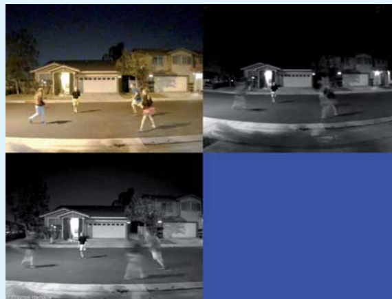
Fot. Porównanie jakości obrazów z kamer HD zarejestrowanych w nocy: z kamery super low lux (lewy górny), low lux (lewy dolny) i z kamery standardowej (prawy górny)
