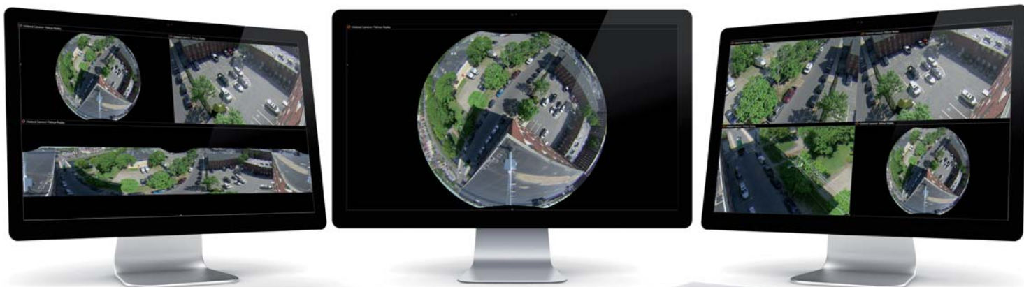
Fot. 2. Widok z jednej kamery zewnętrznej Oncam Grandeye IP Evolution 360° prezentujący technikę korekcji zniekształceń geometrycznych obrazu. Widoczny jest podgląd w tradycyjnej przeglądarce prezentujący obrazy przybliżone, panoramę i widok 360°
