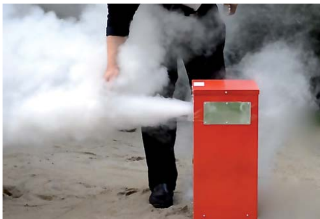
Fot. 2. Generator aerozolu gaśniczego w trakcie gaszenia
