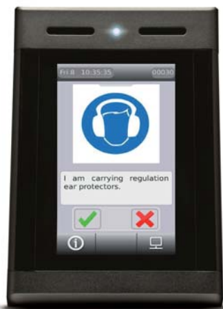
Fot. 3. Terminal emerald wyświetlający listę kontrolną
