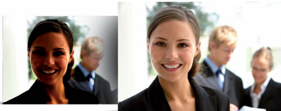
Fot. 1. Porównanie obrazów uzyskanych z włączoną i wyłączoną funkcją WDR
