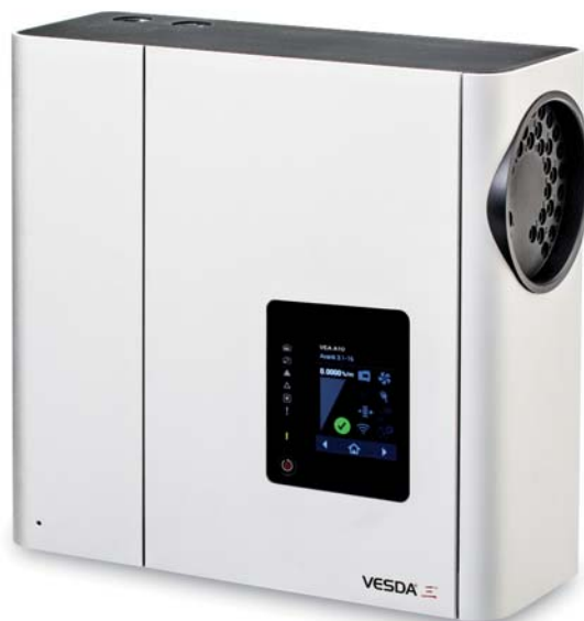
Fot. 3. Czujka VESDA VEA rozróżniająca 40 cienkich kapilar o średnicach 4 mm/6 mm i długości do 100 m
