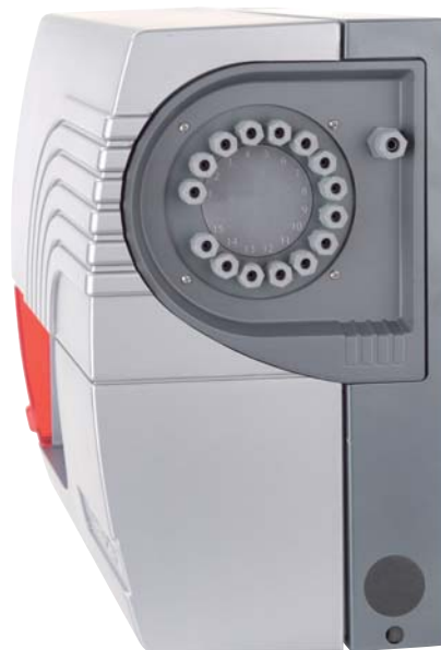
Fot. 2. Czujka VESDA FT-15 rozróżniająca 15 cienkich kapilar o średnicach 4 mm/6 mm i długości 50 m
