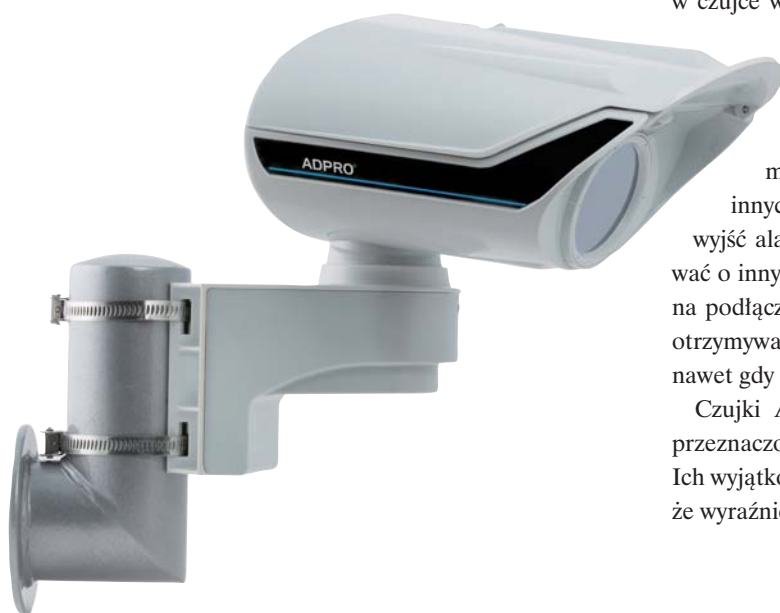
Fot. 1. Pasywna czujka podczerwieni ADPRO by Xtralis z serii PRO E
