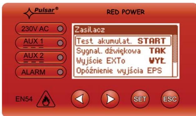
Fot. 1. Załączenie testu akumulatora – zasilacz z wyświetlaczem LED
