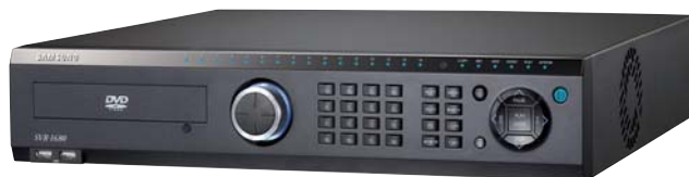
Fot. 1. Model SVR-1680 (16-kanalowy cyfrowy rejestrator wizyjny, prędkość zapisu 480 kl/s przy rozdzielczości D1)
