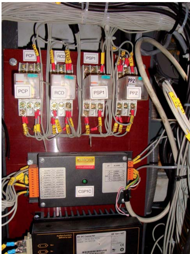
Rys. 6. Widok koncentratora typu CSP1C zainstalowanego w wagonie pasażerskim
