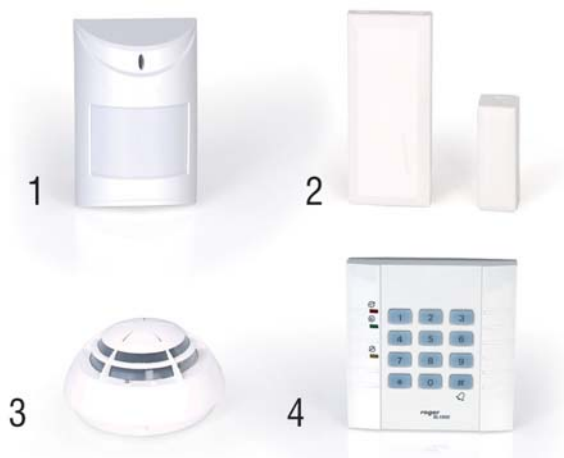
Fot. 4. Elementy systemu alarmowego: 1 – pasywna czujka podczerwieni typu Satel Aqua, 2 – czujka kontaktronowa, 3 – optyczna czujka dymu typu ADR-20N, 4 – zamek typu Roger SL1000
