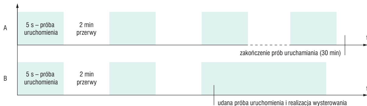
Rys. 4. Realizacja funkcji „Dead-Lock”: A – nieudaneysterowanie B –ysterowanie zakończone sukcesem
