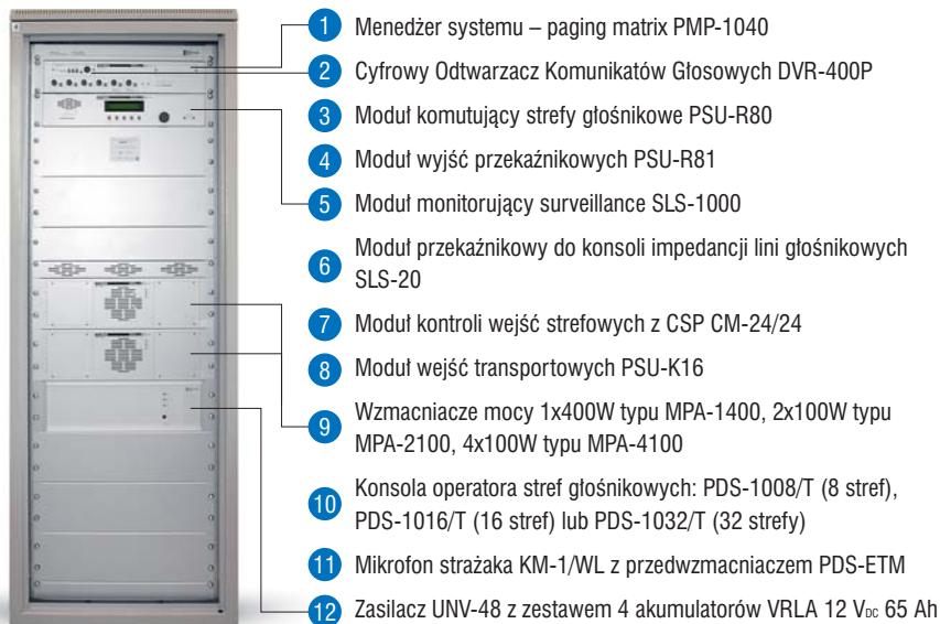
Rys. 1. Przykładowa konfiguracja systemu w szafie teleinformatycznej
