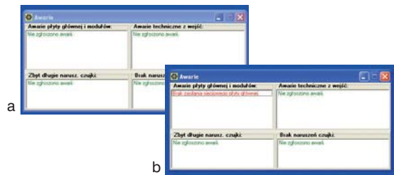
Rys. 3. Widok okna „Awarie”: a) w przypadku braku awarii, b) w przypadku braku zasilania podstawowego płyty głównej centrali alarmowej
