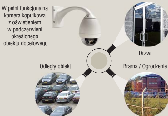
Rys. 2. Sposób 2 – Oświetlenie określonego obiektu docelowego
