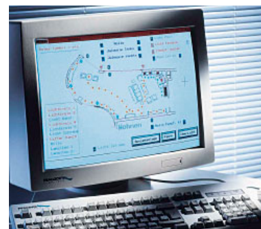
Rys. 5. Wizualizacja zdarzeń w systemie EIB przy pomocy oprogramowania do wizualizacji na ekranie komputera
