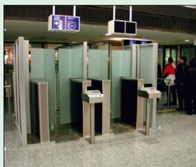
Rys. 1. System rozpoznający tęczy oka – wybrany w 2004 r. do projektu pilotażowego biometrycznej kontroli granicznej (ang. Automated and Biometrics – Supported Border Controls, ABG) w porcie lotniczym we Frankfurcie nad Menem.
