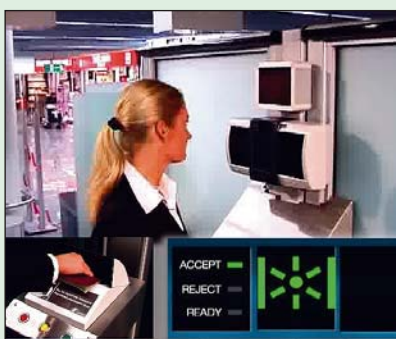
Rys. 1. System rozpoznający tęczy oka – wybrany w 2004 r. do projektu pilotażowego biometrycznej kontroli granicznej (ang. Automated and Biometrics – Supported Border Controls, ABG) w porcie lotniczym we Frankfurcie nad Menem.
