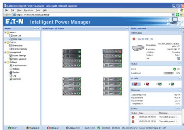
Fot. 1. Intelligent Power Manager – darmowe oprogramowanie do zarządzania elementami niezawodnej sieci zasilającej
