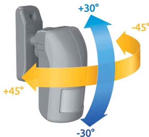
Fot. 3. Uchwyt kulowy zapewnia możliwość regulacji kąta nachylenia i obrotu czujki – maksymalnie o 60 stopni w pionie i 90 w poziomie
