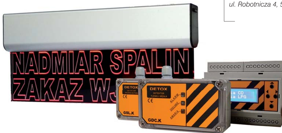
Fot. 6. Zestaw do detekcji CO i LPG, moduł sterujący oraz tablica sygnalizacyjna (detektory CO i LPG komunikujące się przez MODBUS, tablica pomiarowa)
