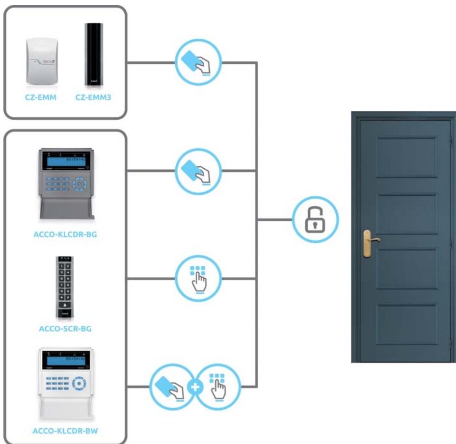
Rys. 1. Możliwości identyfikacji użytkownika w systemie kontroli dostępu ACCO
