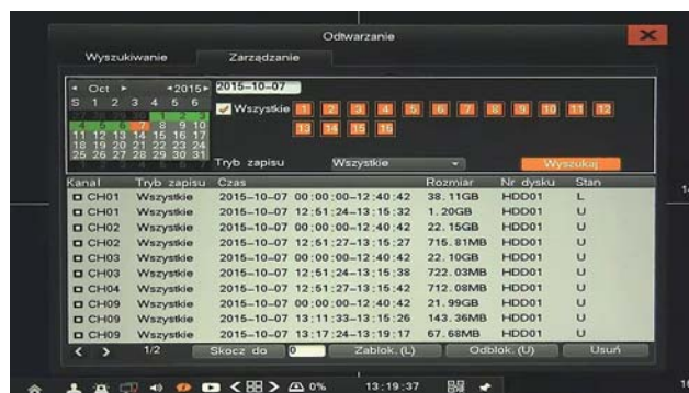
Fot. 4. Menu blokowania nagrań rejestratora uniemożliwiającego ich nadpisanie
