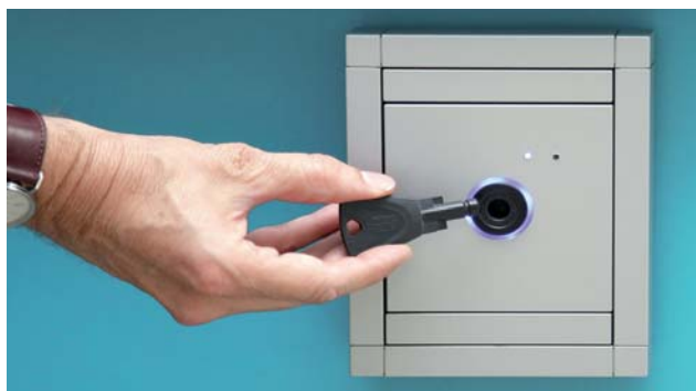
Fot. 4. Podczas kontaktu klucza z czytnikiem dane dotyczące praw dostępu w systemie blueSmart są aktualizowane
