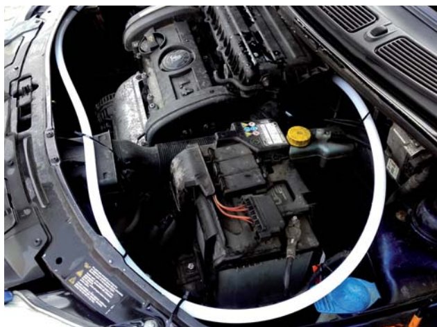
Fot. 3. PROTENG ENGINE – system o długości 2,1 m, dostosowany do kubatury 1 m 3 (komory silników pojazdów mechanicznych, np. samochodów osobowych, duże szafy serwerowe, rozdzielnie elektryczne itp.)
