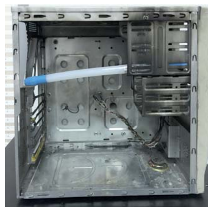
Fot. 1. PROTENG IT – system o długości 40 cm, dostosowany do kubatury 0,25 m 3 (komputery, małe szafy typu rack)
