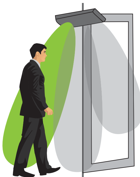
Rys. 2. Wykrywanie kierunku ruchu osoby przechodzącej przez drzwi
