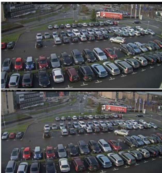
Fot. 1. Na zdjęciu u góry przedstawiony jest zwykły strumień wizyjny (o przepływności 1254 kb/s), a poniżej ten sam strumień wizyjny (o przepływności 601 kb/s) po uaktywnieniu funkcji Axis Zipstream o przepływności 601 kb/s
