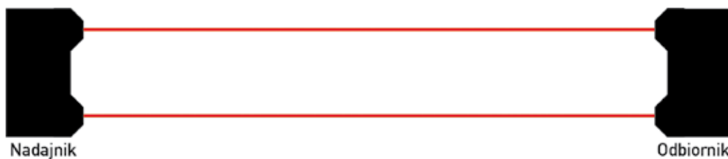
Rys. 1. Schemat dwuwiązkowej bariery podczerwieni ilustrujący zasadę działania urządzenia
