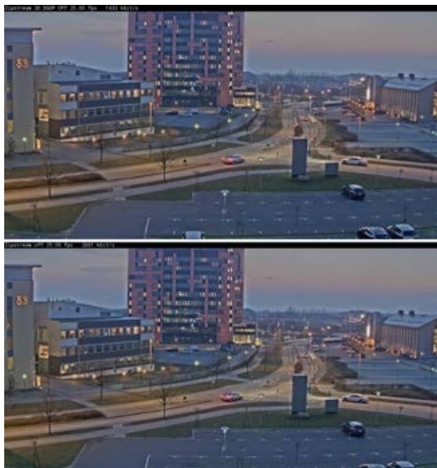
Fot. 2. Na zdjęciu u góry przedstawiony jest ten sam strumień wizyjny po uaktywnieniu funkcji Axis Zipstream, (przepływność 1433 kb/s), a poniżej zwykły strumień wizyjny, (25 klatek na sekundę, przepływność 2881 kb/s)
