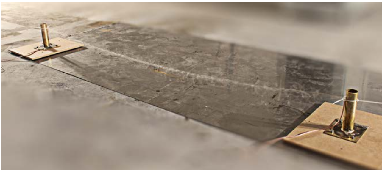
Fot. 1. Słabe rozprzestrzenianie się dymu w czasie testu polegającego na przegrzaniu izolacji (fot. „Zabezpieczenia”)
