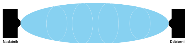
Rys. 3. Schemat działania bariery mikrofalowej
