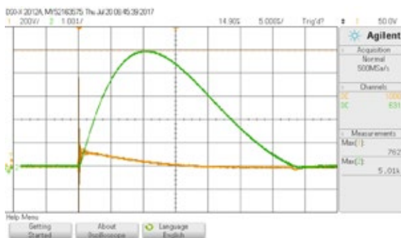
Rys. 2. Przykładowy przebieg udaru prądowego 8/20 \mu s (kolor zielony) i napięcia zmierzonego na zaciskach wyjściowych ogranicznika przepięć (kolor pomarańczowy) zarejestrowane w czasie badań porównawczych
