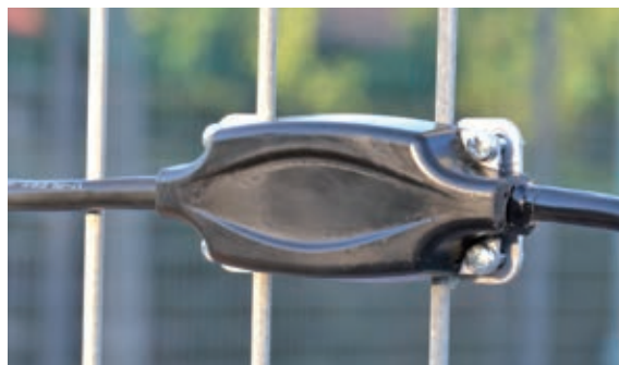
Fot. 2. Sensor VAF3 zainstalowany na ogrodzeniu
