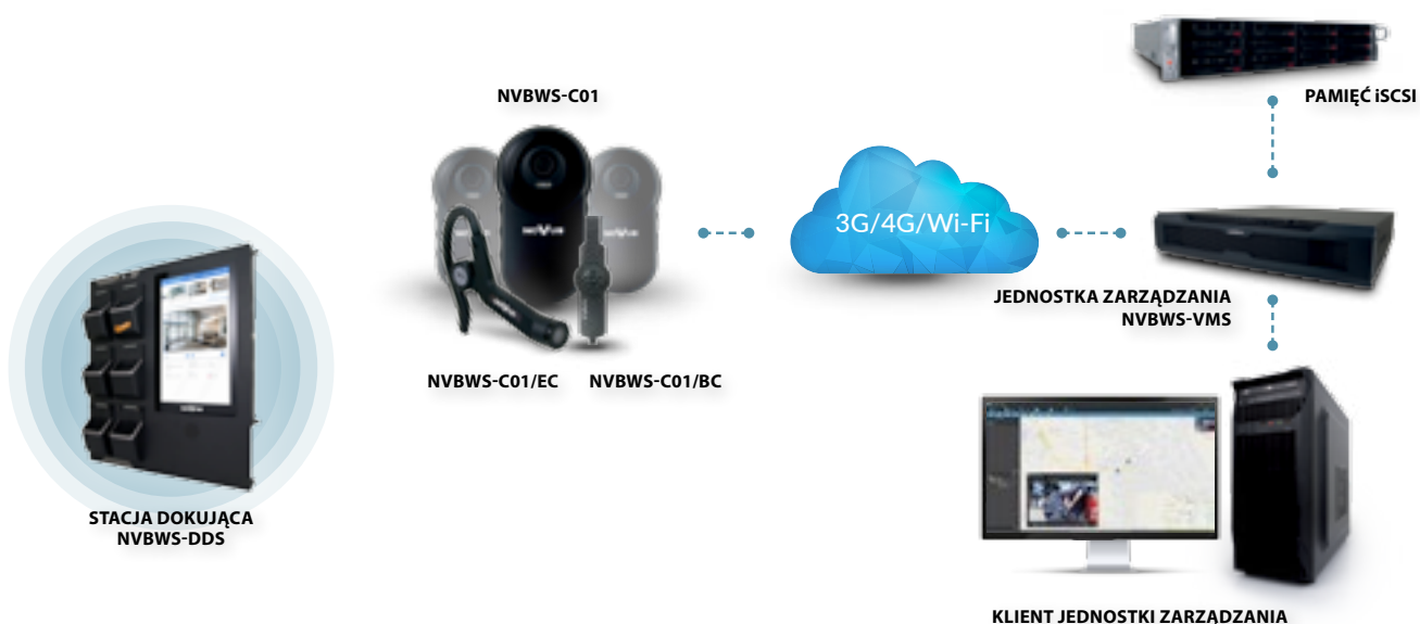
Rys. 3. Architektura systemu nasobnego marki NOVUS
