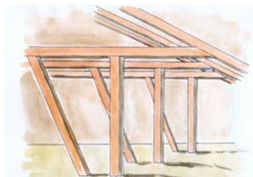
Rys. 6. Zastosowanie mgły wodnej - więzby dachowe
