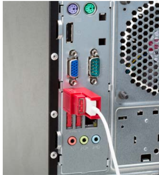
Fot. 2. Blokady portów USB, zabezpieczenie przed odłączeniem urządzenia z portu USB
