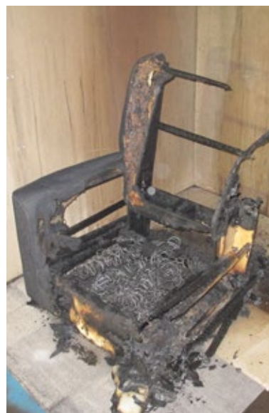
Fot. 1. Pożar autentycznego tapicerskiego fotela. Zdjęcia zostały zrobione na krótko przed uruchomieniem się tryskacza (z trzylimetrową ampułką pękającą w temperaturze 68°C), dwie minuty po jego uruchomieniu się oraz po teście. Wydatek wody wyniósł 30,3 l/min. Zdjęcia: Magnus Arvidson, RISE Fire Research
