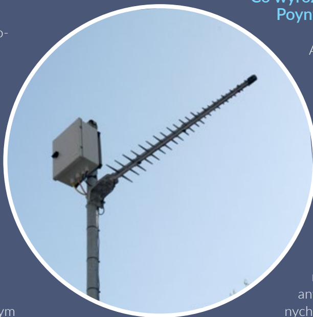
Fot. 4. Kierunkowe anteny Poynting LDPA-92 umożliwiają połączenie ze stacją BTS na odległość 15 km (Autor: Poynting Europe GmbH)
