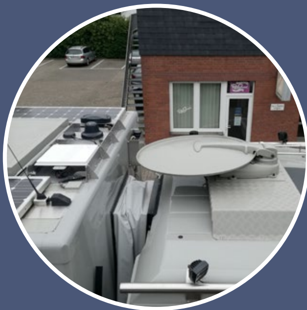
Fot. 3. Wielofunkcyjna antena Poynting MIMO-1 zamontowana na ciężarówce. We wspólnej obudowie znajdują się dwie anteny LTE, antena GPS/Glonass oraz dwie anteny Wi-Fi (na pasma 2.4 i 5GHz)
