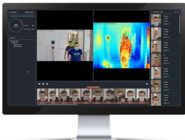
Rys. 2. Równoczesny pomiar temperatur ciał wielu osób
