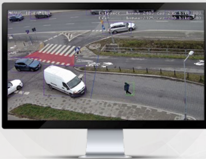
Rys. 3. Zliczanie przekroczeń wyznaczonej linii
