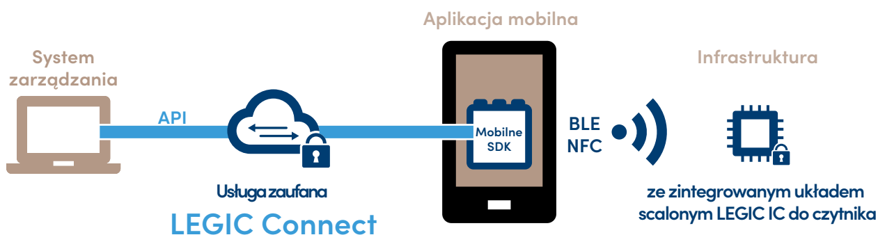
Rys. 1. Wyjaśnienie zasady działania usługi LEGIC Connect
