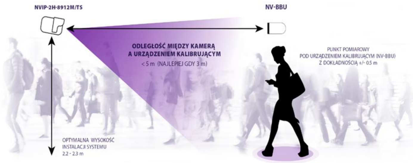
Rys. 1. Zasady montażu zestawu NVIP-2H-8912M/TS SET
